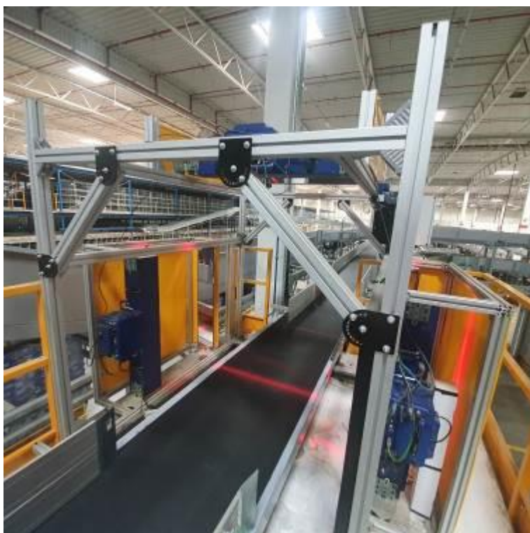
Widok na skaner rozdzielający przesyłki na poszczególne kierunki, mając na uwadze ich rodzaj, ciężar, kierunek nadania
